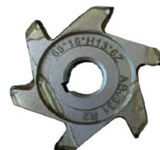
Фреза АЛМАЗНАЯ для снятия свесов
